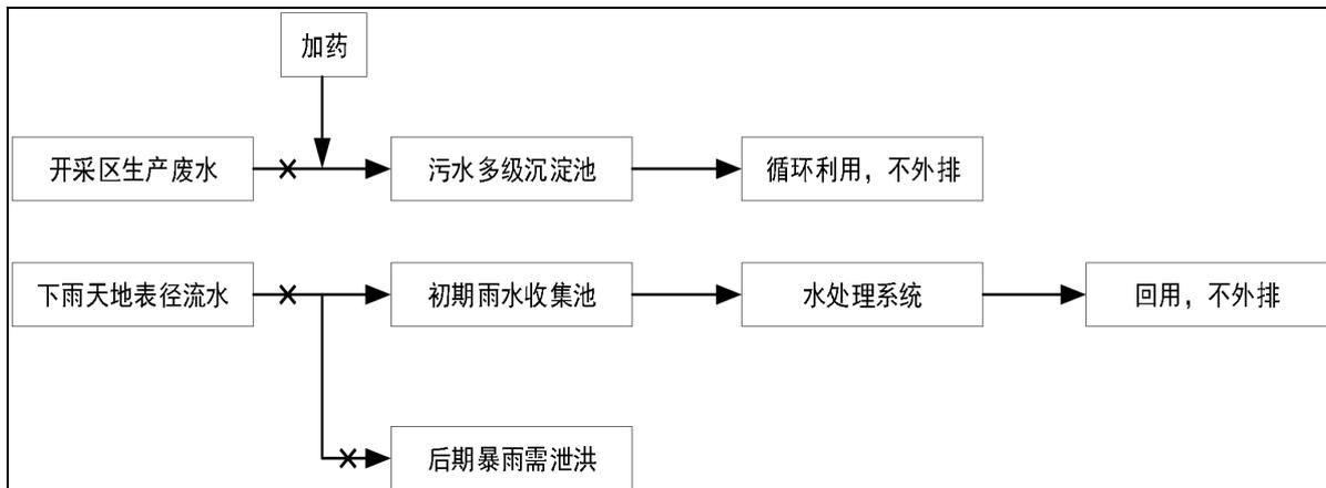
图 2-3 污、雨水收集池分流建设原则示意图
