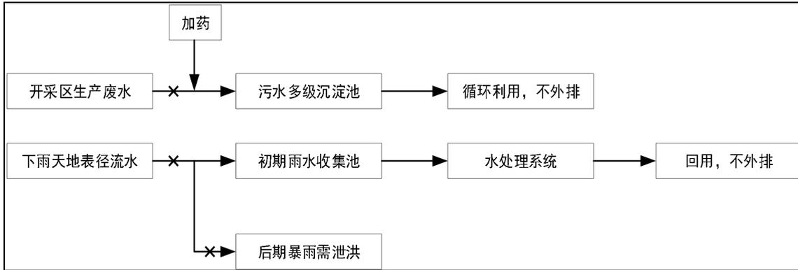
图 4-7 污、雨水收集池分流建设原则示意图
