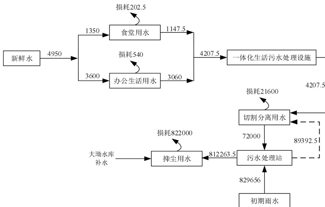
图 4-4 项目年水平衡图 单位：m<sup>3</sup>/a
