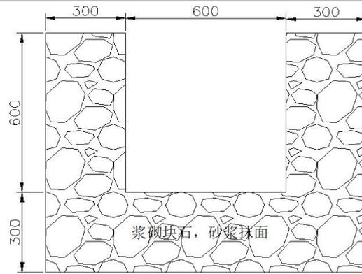
图 4-9 设计截排水沟断面图
