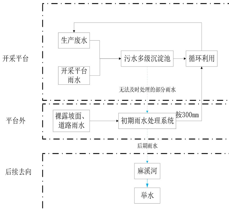
图 4-3 本项目排水流程示意图
