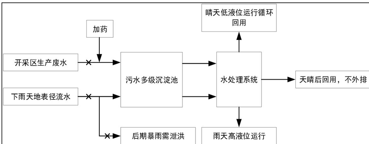
图 4-8 污、雨水收集池分流建设原则示意图
